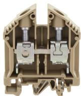
Ex-Durchgangsklemme zertifiziert nach ATEX, Schraubanschluss, Montageart: TS 35/7,5 und TS 32, Bemessungsquerschnitt: 35 mm<sup>2</sup>, Breite: 16 mm, Farbe: Beige
