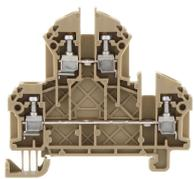
Doppelstockklemme, Schraubanschluss, Montageart: TS 35/7,5, Bemessungsquerschnitt: 2,5 mm<sup>2</sup>, Breite: 5 mm, Farbe: Beige
