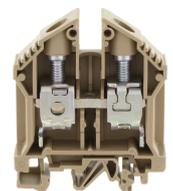
Durchgangsklemme, Schraubanschluss, Montageart: TS 35/7,5 und TS 32, Bemessungsquerschnitt: 35 mm<sup>2</sup>, Breite: 16 mm, Farbe: Beige
