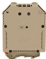
Ex-Durchgangsklemme zertifiziert nach ATEX, Schraubanschluss, Montageart: TS 35/7,5 und TS 32, Bemessungsquerschnitt: 240 mm<sup>2</sup>, Breite: 36 mm, Farbe: Beige
