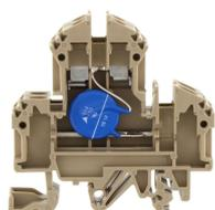
Doppelstockklemme mit elektronischen Bauteilen, Schraubanschluss, Montageart: TS 35/7,5 und TS 32, Bemessungsquerschnitt: 4 mm<sup>2</sup>, Breite: 12 mm, Farbe: Beige
