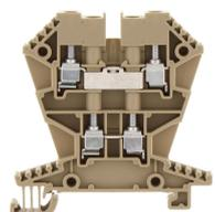
Ex-Doppelstockklemme zertifiziert nach ATEX, Schraubanschluss, Montageart: TS 35/7,5
