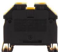
Durchgangsklemme, Schraubanschluss, Montageart: TS 35/7,5, Bemessungsquerschnitt: 16 mm<sup>2</sup>, Breite: 12 mm, Farbe: Schwarz-gelb
