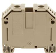
Durchgangsklemme, Schraubanschluss, Montageart: TS 35/7,5, Bemessungsquerschnitt: 35 mm<sup>2</sup>, Breite: 16 mm, Farbe: Beige
