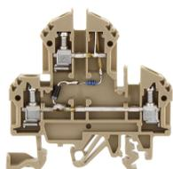
Doppelstockklemme mit elektronischen Bauteilen, Schraubanschluss, Montageart: TS 35/7,5 und TS 32, Bemessungsquerschnitt: 4 mm<sup>2</sup>, Breite: 6 mm, Farbe: Beige
