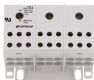
Schraub-Verteiler-Block, Schraubanschluss, Montageart: TS 35/7,5 und Montagefläche, Bemessungsquerschnitt Eingang: 70 mm<sup>2</sup>, Bemessungsquerschnitt Ausgang: 16 mm<sup>2</sup>, Farbe: Lichtgrau
