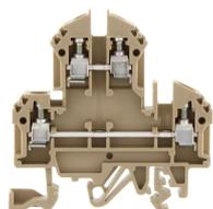
Ex-Doppelstockklemme zertifiziert nach ATEX, Schraubanschluss, Montageart: TS 35/7,5 und TS 32, Bemessungsquerschnitt: 4 mm<sup>2</sup>, Breite: 5 mm, Farbe: Beige
