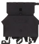
Sicherungsklemme mit Trennstecker, Schraubanschluss, Montageart: TS 35/7,5 und TS 32, Bemessungsquerschnitt: 10 mm<sup>2</sup>, Breite: 10 mm, Farbe: Schwarz
