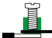
Durchgangsklemme, Schraubanschluss, Montageart: TS 35/7,5 und TS 32,
