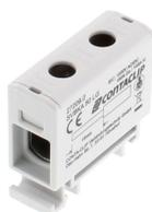
Schraub-Verteiler-Block, Schraubanschluss, Montageart: TS 35/7,5 und Montagefläche, Bemessungsquerschnitt Eingang: 50 mm<sup>2</sup>, Bemessungsquerschnitt Ausgang: 50 mm<sup>2</sup>, Farbe: Lichtgrau
