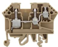
Durchgangsklemme, Schraubanschluss, Montageart: TS 35/7,5 und TS 32, Bemessungsquerschnitt: 4 mm<sup>2</sup>, Breite: 6 mm, Farbe: Beige
