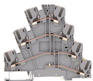
Motoranschlussklemme, Push-in-Anschluss, Montageart: TS 35/7,5, Bemessungsquerschnitt: 2,5 mm<sup>2</sup>, Breite: 5,1 mm, Farbe: Grau
