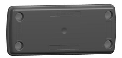
Blindplatte zur Abdeckung von Durchbrüchen für Kabeldurchführungen KDS und KES, Montageart: Schrauben, Länge: 126 mm, Breite: 55 mm, Höhe: 11,5 mm, Material: Polyamid 6.6, Dichtmaterial TPE
