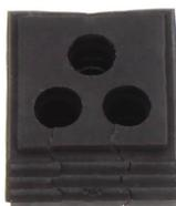
Dichtelement, Montageart: Stecken, Länge x Breite: 20,3 mm, Kabeldurchmesser max.: 6,5 mm, IP66, Farbe: Schwarz
