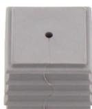
Dichtelement, Montageart: Stecken, Länge x Breite: 20,3 mm, Kabeldurchmesser max.: 2 mm, IP66, Farbe: Grau
