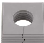
Dichtelement, Montageart: Stecken, Länge x Breite: 42,8 mm, Kabeldurchmesser max.: 21 mm, IP66, Farbe: Grau
