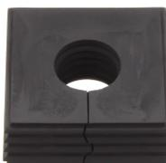
Dichtelement, Montageart: Stecken, Länge x Breite: 42,8 mm, Kabeldurchmesser max.: 18 mm, IP66, Farbe: Schwarz
