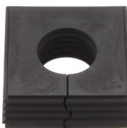
Dichtelement, Montageart: Stecken, Länge x Breite: 42,8 mm, Kabeldurchmesser max.: 21 mm, IP66, Farbe: Schwarz
