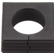
Dichtelement, Montageart: Stecken, Länge x Breite: 42,8 mm, Kabeldurchmesser max.: 28 mm, IP66, Farbe: Schwarz
