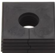
Dichtelement, Montageart: Stecken, Länge x Breite: 42,8 mm, Kabeldurchmesser max.: 17 mm, IP66, Farbe: Schwarz
