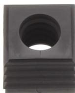
Dichtelement, Montageart: Stecken, Länge x Breite: 20,3 mm, Kabeldurchmesser max.: 12 mm, IP66, Farbe: Schwarz
