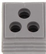
Dichtelement, Montageart: Stecken, Länge x Breite: 20,3 mm, Kabeldurchmesser max.: 6 mm, IP66, Farbe: Grau
