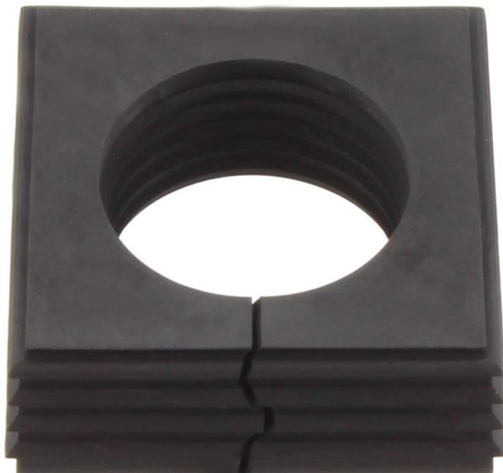
Dichtelement, Montageart: Stecken, Länge x Breite: 42,8 mm, Kabeldurchmesser max.: 28 mm, IP66, Farbe: Schwarz
