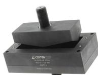
Blechlocher für rechteckige Ausbrüche, Maße Ausbruch: 130 x 46 mm, Maximale Wandstärke: 2,0 mm bei Edelstahlblech, Material: Stahl
