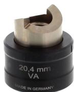
Blechlocher für runde Ausbrüche, Durchmesser Ausbruch: 20,4 mm, Maximale Wandstärke: 2,0 mm bei Edelstahlblech, Material: Stahl
