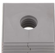
Dichtelement, Montageart: Stecken, Länge x Breite: 42,8 mm, Kabeldurchmesser max.: 15 mm, IP66, Farbe: Grau
