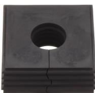
Dichtelement, Montageart: Stecken, Länge x Breite: 42,8 mm, Kabeldurchmesser max.: 17 mm, IP66, Farbe: Schwarz
