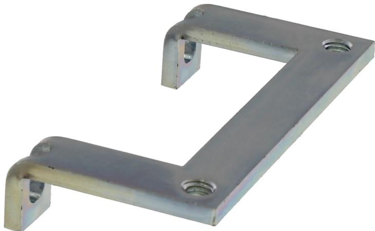
Schirmanschlussschiene zur Montage von Schirmanschlussbügeln direkt an der Kabeldurchführung KDS, Montageart: Schrauben, Länge: 35,3 mm, Breite: 68 mm, Höhe: 16 mm, Profil: 10x3 mm
