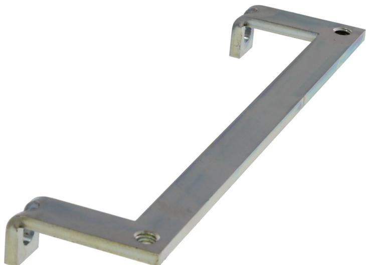
Schirmanschlussschiene zur Montage von Schirmanschlussbügeln direkt an den Kabeldurchführungen KDS-FP, Montageart: Schrauben, Länge: 35,3 mm, Breite: 152 mm, Höhe: 16 mm, Profil: 10x3 mm
