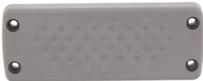
Kabeleinführung mit Membrane für nicht konfektionierte Leitungen, Montageart: Schrauben, Länge: 147 mm, Breite: 58 mm, IP66, Farbe: Grau
