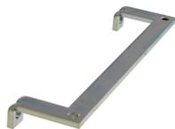
Schirmanschlussschiene zur Montage von Schirmanschlussbügel direkt an den Kabeldurchführungen KDS und KES, Montageart: Schrauben, Länge: 35,3 mm, Breite: 140 mm, Höhe: 16 mm, Profil: 10x3 mm
