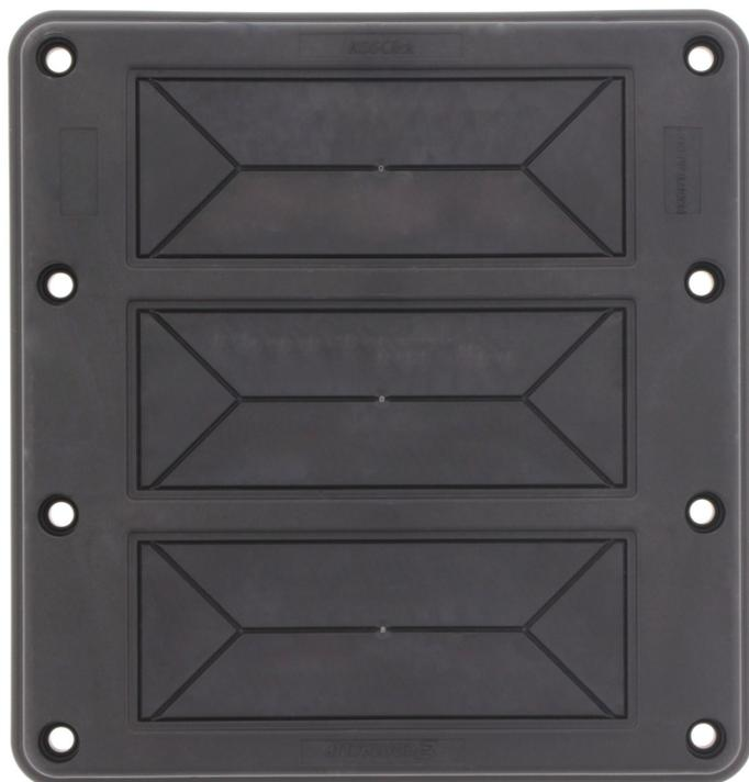
Kabeldurchführung Flanschplatte mit eingeschäumter Dichtung, Montageart: Schrauben, Länge: 165 mm, Breite: 174 mm, IP66, Farbe: Schwarz
