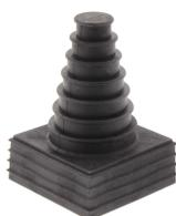
Dichtelement, Montageart: Stecken, Länge x Breite: 42,8 mm, Kabeldurchmesser max.: 24 mm, IP66, Farbe: Schwarz
