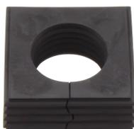
Dichtelement, Montageart: Stecken, Länge x Breite: 42,8 mm, Kabeldurchmesser max.: 26 mm, IP66, Farbe: Schwarz
