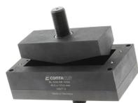
Blechlocher für rechteckige Ausbrüche, Maße Ausbruch: 68 x 24 mm, Maximale Wandstärke: 2,0 mm bei S 235 Blech, Material: Stahl
