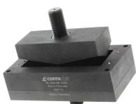
Blechlocher für rechteckige Ausbrüche, Maße Ausbruch: 68 x 24 mm, Maximale Wandstärke: 2,0 mm bei Edelstahlblech, Material: Stahl
