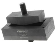
Blechlocher für rechteckige Ausbrüche, Maße Ausbruch: 68 x 24 mm, Maximale Wandstärke: 2,0 mm bei S 235 Blech, Material: Stahl
