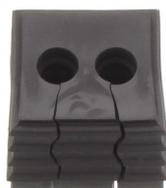
Dichtelement, Montageart: Stecken, Länge x Breite: 20,3 mm, Kabeldurchmesser max.: 6 mm, IP66, Farbe: Schwarz
