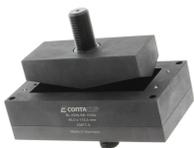
Blechlocher für rechteckige Ausbrüche, Maße Ausbruch: 89 x 24 mm, Maximale Wandstärke: 2,0 mm bei S 235 Blech, Material: Stahl
