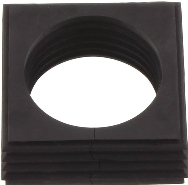
Dichtelement, Montageart: Stecken, Länge x Breite: 42,8 mm, Kabeldurchmesser max.: 34 mm, IP66, Farbe: Schwarz
