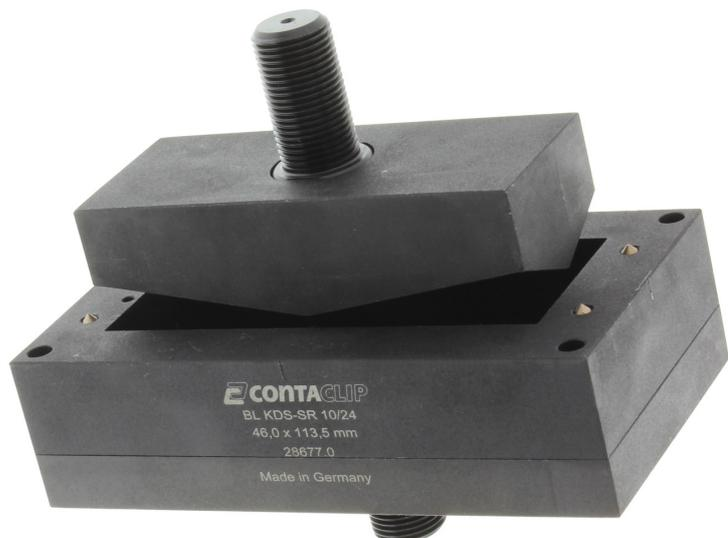
Blechlocher für rechteckige Ausbrüche, Maße Ausbruch: 111 x 24 mm, Maximale Wandstärke: 2,0 mm bei S 235 Blech, Material: Stahl
