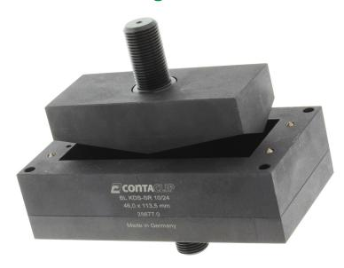
Blechlocher für rechteckige Ausbrüche, Maße Ausbruch: 111 x 24 mm, Maximale Wandstärke: 2,0 mm bei Edelstahlblech, Material: Stahl
