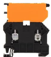
Sicherungstrennklemme, Schraubanschluss, Montageart: TS 35/7,5, Bemessungsquerschnitt: 6 mm<sup>2</sup>, Breite: 8,1 mm, Farbe: Schwarz
