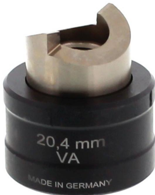
Blechlocher für runde Ausbrüche, Durchmesser Ausbruch: 20,4 mm, Maximale Wandstärke: 2,0 mm bei Edelstahlblech, Material: Stahl
