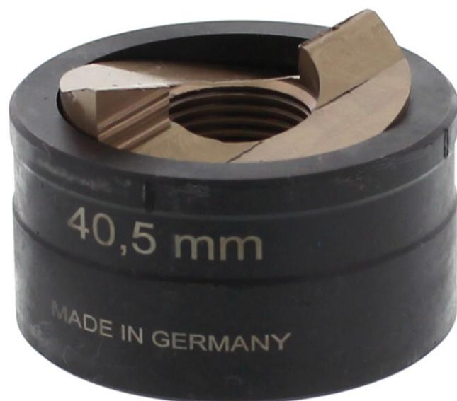
Blechlocher für runde Ausbrüche, Durchmesser Ausbruch: 40,5 mm, Maximale Wandstärke: 2,0 mm bei Edelstahlblech, Material: Stahl
