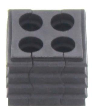
Dichtelement, Montageart: Stecken, Länge x Breite: 20,3 mm, Kabeldurchmesser max.: 6,1mm, IP66, Farbe: Schwarz
