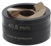
Blechlocher für runde Ausbrüche, Durchmesser Ausbruch: 40,5 mm, Maximale Wandstärke: 2,0 mm bei Edelstahlblech, Material: Stahl
