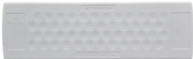
Kabeleinführung mit Membrane für nicht konfektionierte Leitungen, Montageart: Rasten, Länge: 142 mm, Breite: 44 mm, IP64, Farbe: Grau
