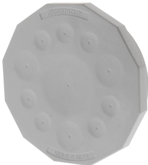
Runde Kabeleinführung M50 mit Membrane für nicht konfektionierte Leitungen, Montageart: Rasten, Länge: 60 mm, Breite: 60 mm, IP54, Farbe: Grau
