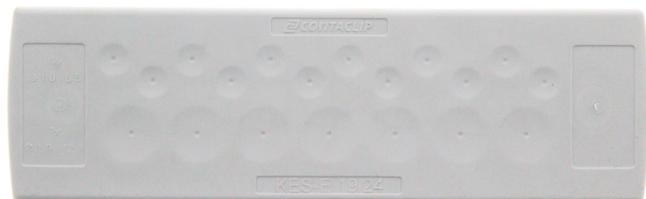
Kabeleinführung mit Membrane für nicht konfektionierte Leitungen, Blechdicke 2,5 - 4 mm, Montageart: Rasten, Länge: 142 mm, Breite: 44 mm, IP54, Farbe: Grau
