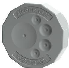
Runde Kabeleinführung M20 mit Membrane für nicht konfektionierte Leitungen, Montageart: Rasten, Länge: 26 mm, Breite: 26 mm, IP54, Farbe: Grau
