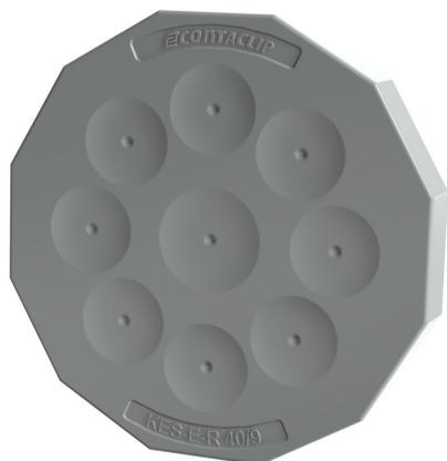
Runde Kabeleinführung M40 mit Membrane für nicht konfektionierte Leitungen, Montageart: Rasten, Länge: 50 mm, Breite: 50 mm, IP54, Farbe: Grau
