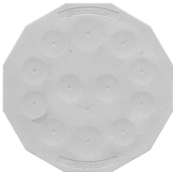
Runde Kabeleinführung M50 mit Membrane für nicht konfektionierte Leitungen, Montageart: Rasten, Länge: 60 mm, Breite: 60 mm, IP54, Farbe: Grau
