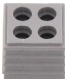
Dichtelement, Montageart: Stecken, Länge x Breite: 20,3 mm, Kabeldurchmesser max.: 6,1 mm, IP66, Farbe: Grau
