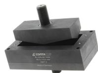
Blechlocher für rechteckige Ausbrüche, Maße Ausbruch: 83 x 46 mm, Maximale Wandstärke: 2,0 mm bei Edelstahlblech, Material: Stahl
