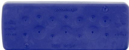
Kabeleinführung mit Membrane für nicht Konfektionierte Leitungen, Montageart: Rasten und Schrauben, Länge: 147 mm, Breite: 58 mm, IP 66, Farbe: Blau, FDA-konformes Material
