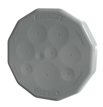
Runde Kabeleinführung M63 mit Membrane für nicht konfektionierte Leitungen, Montageart: Rasten und Schrauben, Länge: 73 mm, Breite: 73 mm, IP66, Farbe: Grau
