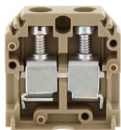
Durchgangsklemme zur Direktmontage, Schraubanschluss, Montageart: Montagefläche, Bemessungsquerschnitt: 10 mm<sup>2</sup>, Breite: 8 mm, Farbe: Beige
