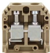
Ex-Durchgangsklemme z. Direktmont. Zertif. n. ATEX, Schraubanschluss, Montageart: Montagefläche, Bemessungsquerschnitt: 10 mm<sup>2</sup>, Breite: 8 mm, Farbe: Beige
