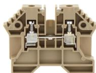
Durchgangsklemme zur Direktmontage/Blockvariante, Schraubanschluss, Montageart: Montagefläche, Bemessungsquerschnitt: 2,5 mm<sup>2</sup>, Breite: 5 mm, Farbe: Beige
