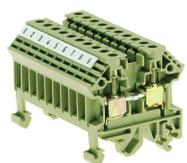
Durchgangsklemme/Blockvariante, Schraubanschluss, Montageart: TS 35/7,5 und TS 32, Bemessungsquerschnitt: 4 mm<sup>2</sup>, Farbe: Beige
