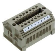
Durchgangsklemme zur Direktmontage/Blockvariante, Schraubanschluss, Montageart: Montagefläche, Bemessungsquerschnitt: 4 mm<sup>2</sup>, Farbe: Beige
