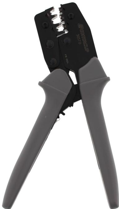
Crimpwerkzeug zum Crimpen von Aderendhülsen mit und ohne Kunststoffkragen. Querschnittsbereich: 10, 16 u. 25 mm<sup>2</sup>. Leichte Handhabung, Zwangssperre für korrektes vollständiges Crimpen, seitliche Leitereinführung, selbstöffnend durch eingebaute Feder.
