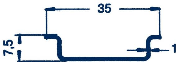
Tragschiene, gelocht, Breite: 35 mm, Höhe: 7,5 mm, Material: Stahl, Farbe: Natur
