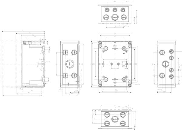
Polystyrol-Gehäuse, Farbe: Grau, RAL: Ähnlich 7035, Deckel: Polycarbonat, Transparent
