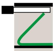
Doppelstockklemme, Push-in-Anschluss, Montageart: TS 35/7,5,
