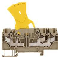
Sicherungstrennklemme, Push-in-Anschluss, Montageart: TS 35/7,5, Bemessungsquerschnitt: 2,5 mm<sup>2</sup>, Breite: 5,1 mm, Farbe: Beige
