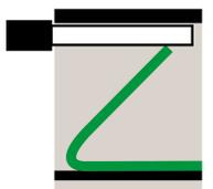
Doppelstockklemme, Push-in-Anschluss, Montageart: TS 35/7,5, Bemessungsquerschnitt: 2,5 mm<sup>2</sup>, Breite: 5,1 mm, Farbe: Beige
