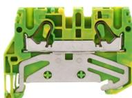
Schutzleiter-Installationsklemme, Push-in-Anschluss, Montageart: TS 35/7,5, Bemessungsquerschnitt: 4 mm<sup>2</sup>, Breite: 5,1 mm, Farbe: Grün-gelb
