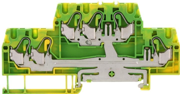
Schutzleiter-Doppelstockklemme, Push-in-Anschluss, Montageart: TS 35/7,5, Bemessungsquerschnitt: 2,5 mm<sup>2</sup>, Breite: 5,1 mm, Farbe: Grün-gelb
