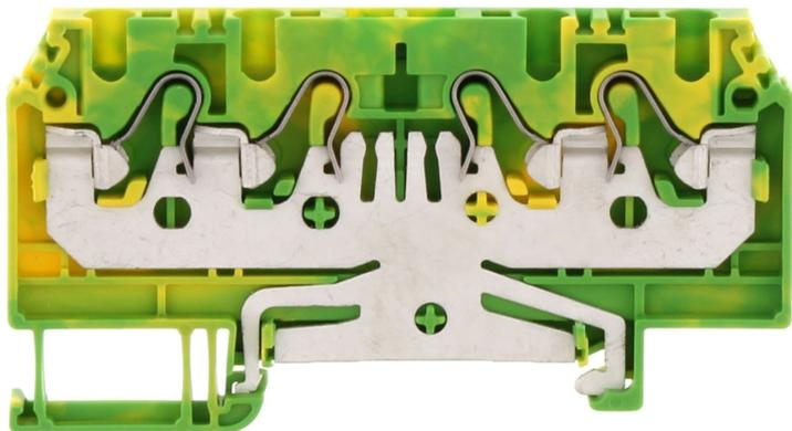
Schutzleiterklemme, Push-in-Anschluss, Montageart: TS 35/7,5, Bemessungsquerschnitt: 2,5 mm<sup>2</sup>, Breite: 5,1 mm, Farbe: Grün-gelb
