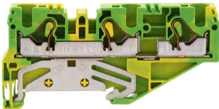
Schutzleiter-Installationsklemme, Push-in-Anschluss, Montageart: TS 35/7,5, Bemessungsquerschnitt: 10 mm<sup>2</sup>, Breite: 8,1 mm, Farbe: Grün-gelb
