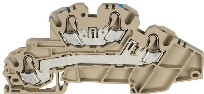
Dreileiter-Installationsklemme, Push-in-Anschluss, Montageart: TS 35/7,5, Bemessungsquerschnitt: 4 mm<sup>2</sup>, Breite: 5,1 mm, Farbe: Beige
