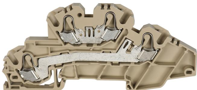
Dreileiter-Installationsklemme, Push-in-Anschluss, Montageart: TS 35/7,5, Bemessungsquerschnitt: 4 mm<sup>2</sup>, Breite: 5,1 mm, Farbe: Beige
