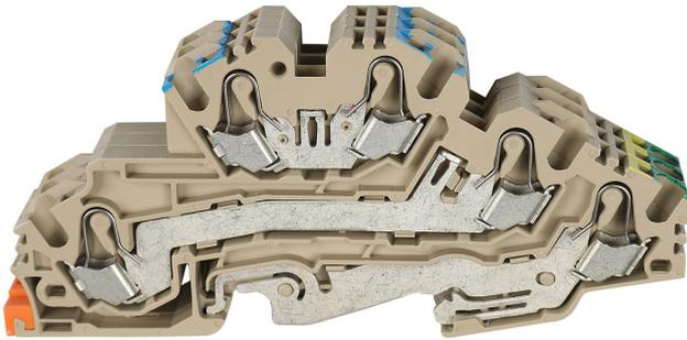
Dreileiter-Installationsklemme, Push-in-Anschluss, Montageart: TS 35/7,5, Bemessungsquerschnitt: 4 mm<sup>2</sup>,
